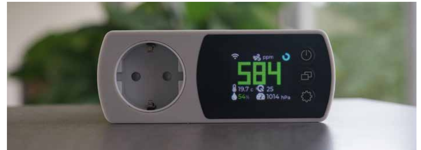
De sensoren geven de docenten goede indicaties om actie ten aanzien van ventilatie te ondernemen.
